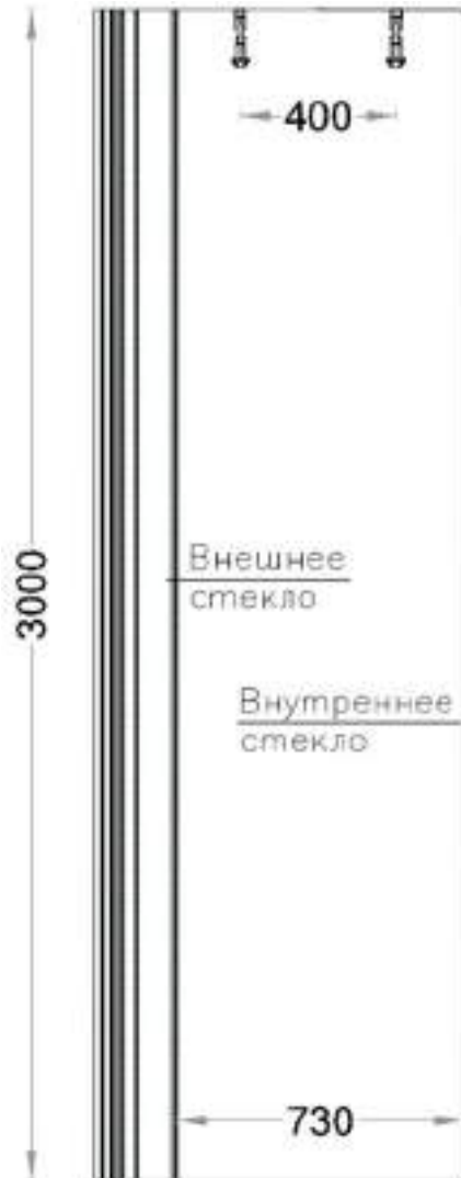
Рисунок В.1 – Пример расположения распылителей дренчерной завесы «MIST E1®» в оконном проеме
